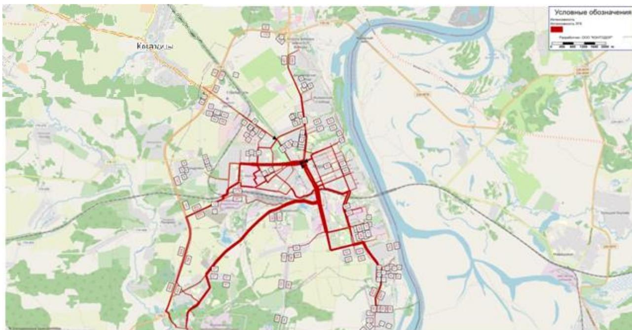
Рис. 3.5.3 - Картограмма расчетной загрузки УДС движением транспорта в час пик в округе Муром
