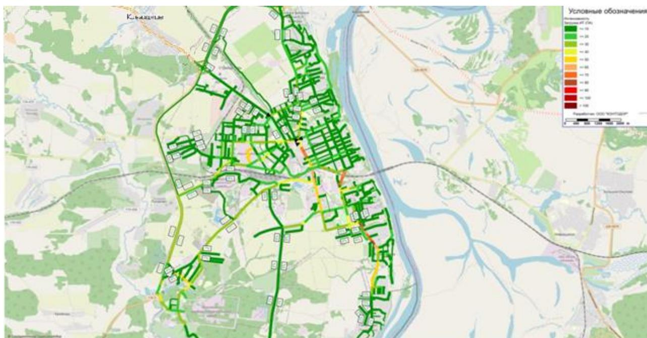
Рис. 3.5.2 - Картограмма расчетной интенсивности движения транспорта в час пик в округе Муром
